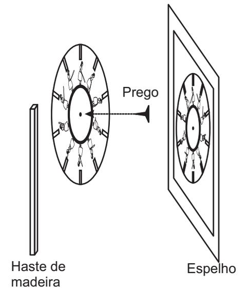
Ao girar o Estroboscópio em frente a um espelho, o espectador percebe o movimento quando olha para a imagem refletida por intermédio dos furos no disco.
